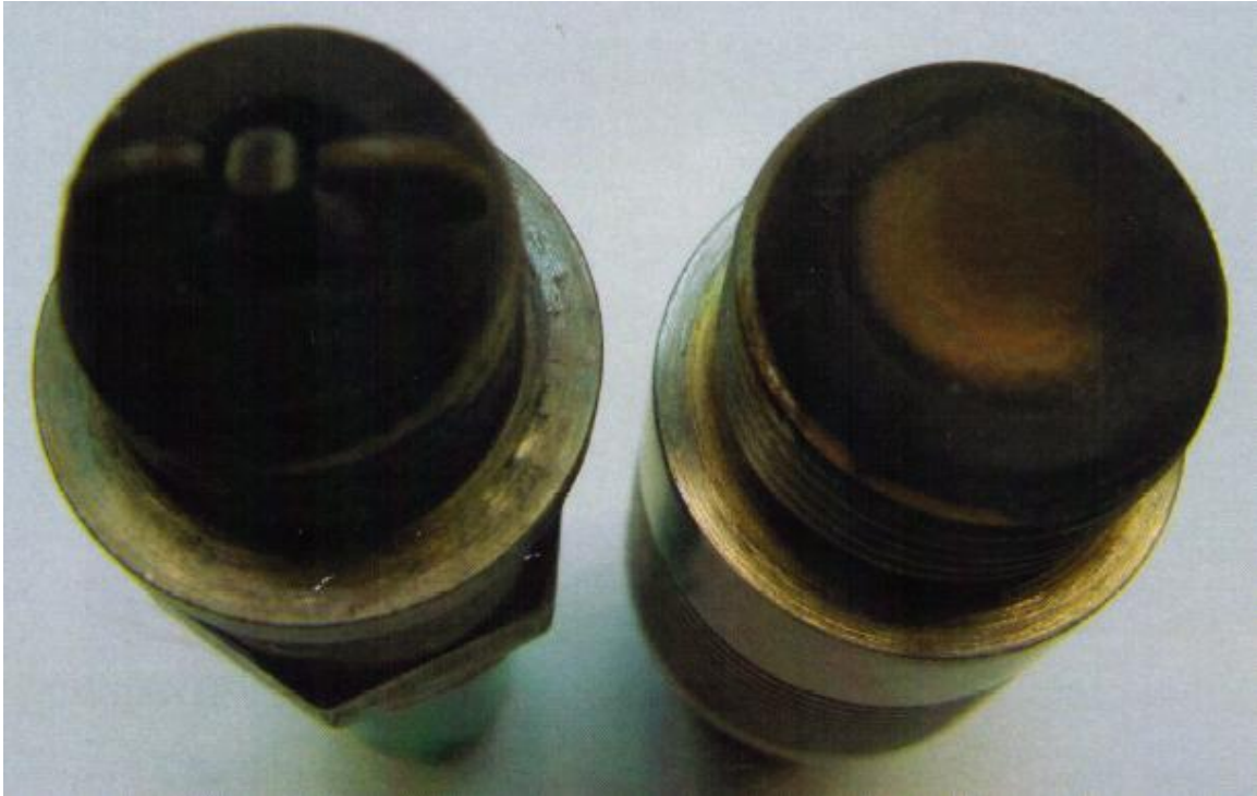
. 图片2 - YIT-85仪器的爆震感应器与火星塞在使用无添加MPG-CAP™加油宝的A-95汽油并测试10小时后的结果。
